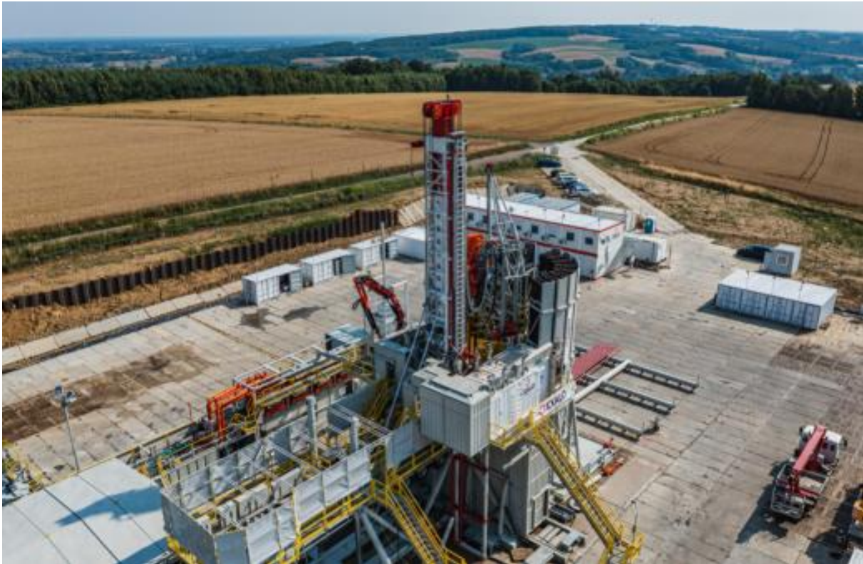
Den dybe 1,9 km boring kræver et 40 m højt boretårn og boring i døgndrift i 70 dage.
